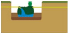
**4.** Rellenar el perímetro con arena y el equipo con agua a la vez, hasta la mitad para evitar sobrepresiones y repetir hasta dejar enterrado.
