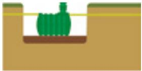
**3.** Colocar el equipo sobre el lecho y conectar canalizaciones de entrada y salida.
