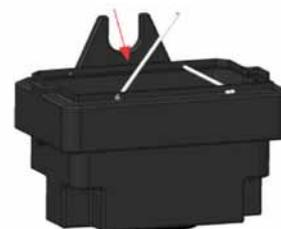
4) Para volver a armar, asegúrese de que las espumas estén correctamente colocadas y cubran toda la superficie del paso del agua. No olvide volver a colocar las varillas y los pasadores.
