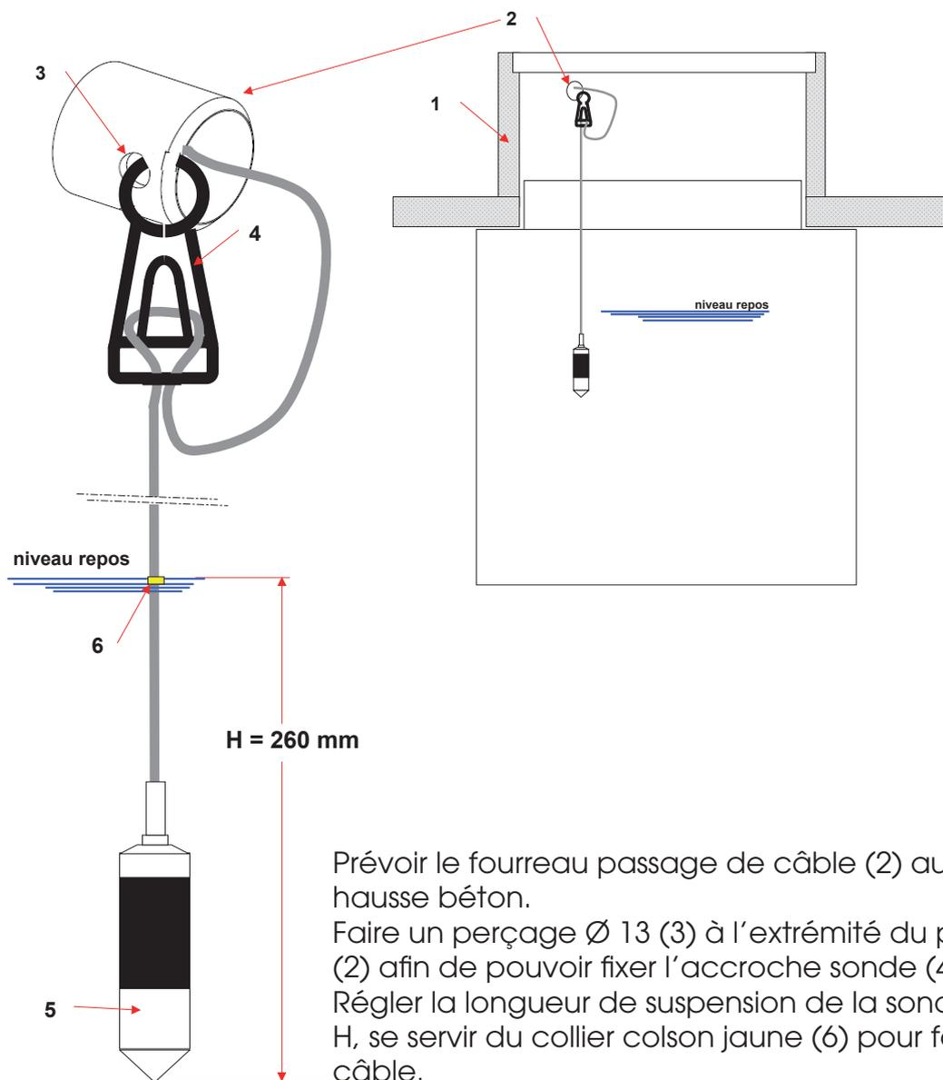
Prévoir le fourreau passage de câble (2) au niveau de la rehausse béton.
